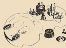
פקק מ-2 חלקים בשיטה המתברגת (עם נתיך וראש מתברג) בהתאם לדרישת VdEW (Siemens - Schuckert, 1909)
