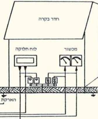
תאור סכמתי של מערכת הגנה בפני ברקים המותקנת על תורן.
