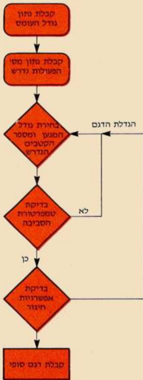
איור 5 דיאגרמת זרימה של השלבים המומלצים בבחירת מגען לעבודה "בחלוקה" (במשטרי עבודה AC1, AC2)
