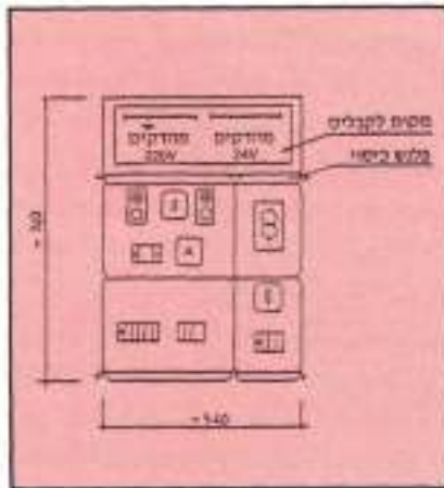
איור 8 לוח חשמל - מיקלט סוג 1-ג
