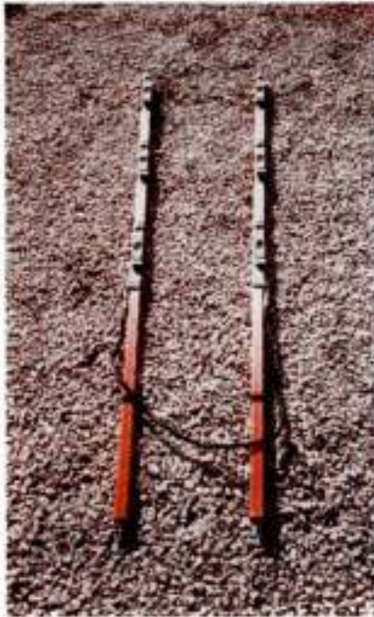
איור 10 מקצר מתח נמוך לרשת חיצונית שנשימוש בחברת החשמל
