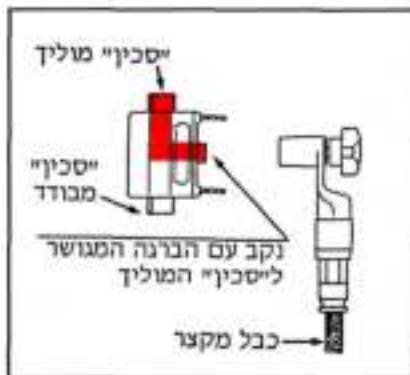
איור 5 מהדק דמויי נתיך למופע וחיבור הכבל המקצר לסכין המוליך
