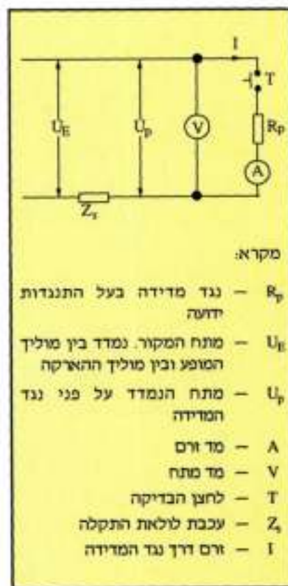
איור 5 מעגל תמורה של חיבור מערך המדידה לצורך מדידת עכבת לולאת התקלה
