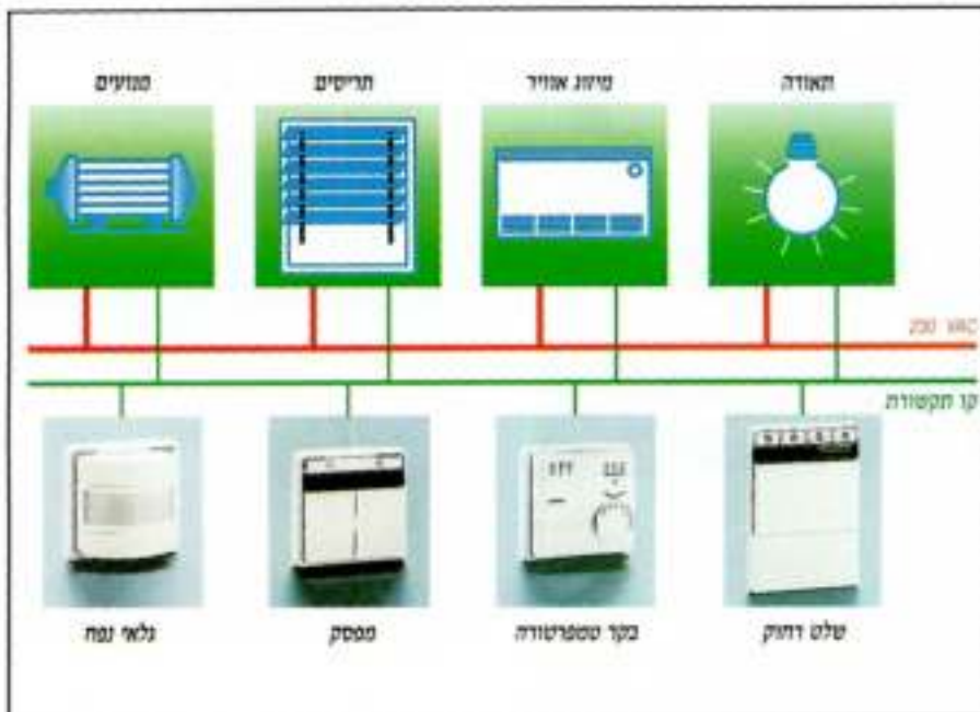
איור 4 תיאור כללי של מערכת Instabus
