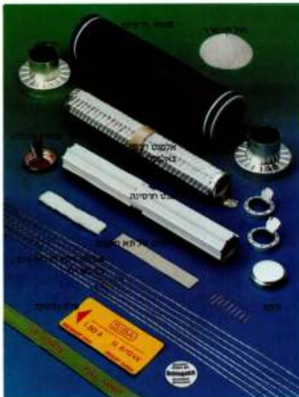
איור 13 המרכיבים של נתיך לתחום שלם על בסיס נתיך גיבוי, בטור עם תא חימום
