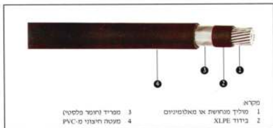
איור 1 כבל מתח נמוך 0.6/1 ק"ו חד גידי (NA2XY, N2XY)
