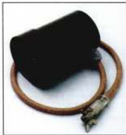
איור 13 שקע לבדיקת כבלים (Cable test socket)
